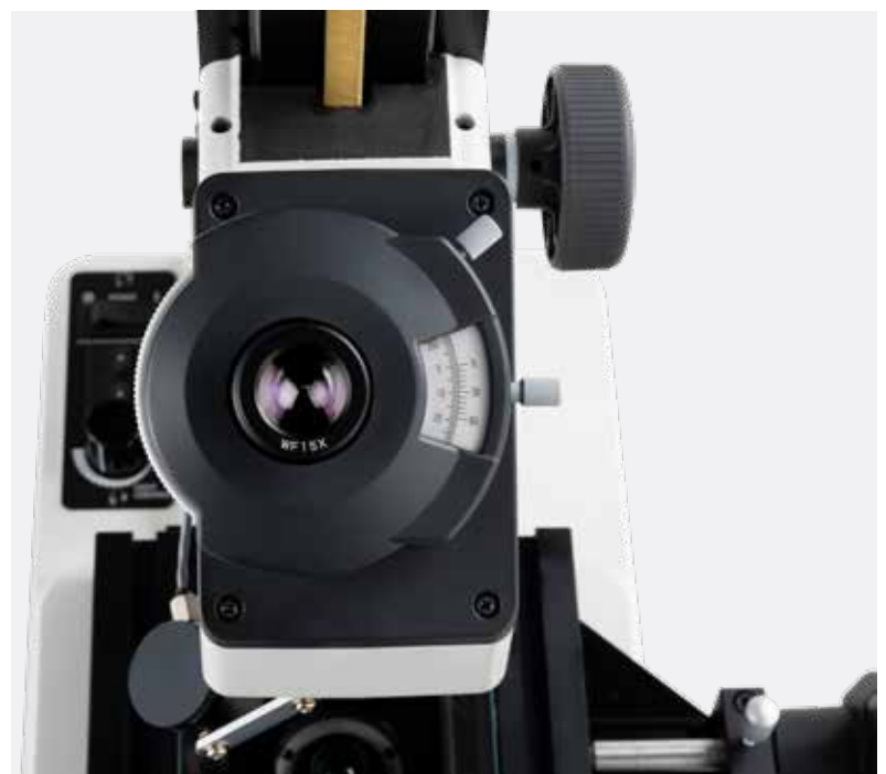
De noniusschaal naast het oculair zorgt voor eenvoudige hoekmetingen.
