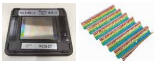
Échantillon de rugosité 3 \mu\text{m}
