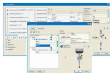
Die Messergebnisse werden in 3D-Ansicht dargestellt und können einschließlich Einstellungen (wie Toleranzen) mittels drag-and-drop zu einem Messreport oder einer Exportdatei hinzugefügt werden.
